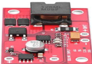
Controlador actual de carga solar, con batería de litio.
